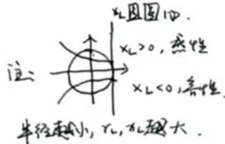
①  $Z_L \rightarrow T_0$ :  $Z_L = \frac{Z_L}{Z_0} = r + jx$ , 找  $r$  圆与  $x$  圆交点为  $T_0$ .
